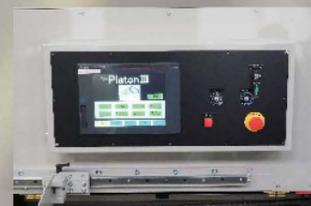
操作盤はタッチパネルを採用。操作はより直感的に。ティーチング機能により一度入力した給紙部、プレス部、バイブレ部、排出部の設定は次回からワンタッチで呼び出し可能。オペレーターの熟練度に関わらず安定した製品品質を提供。セット替えも無類の速さ。
