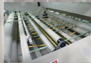
バイブレローラーはツインロール式を採用。これにより回転数の変化だけで振動の強さを広範囲に調整可能に。また、上と下から波形の異なる振動を与えることで効果的なカス取りを実現。
