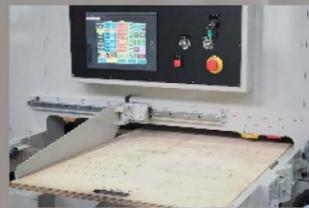
抜き精度は±0.5mm以内。エアリフト搭載しており女性でも簡単に面板の出し入れが可能。ムラ取り、面切り作業も楽々。
